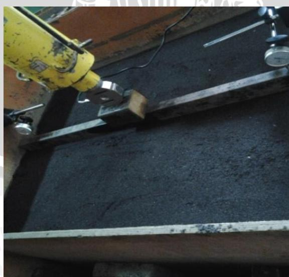
**Gambar 4.9** Proses Keruntuhan Tanah Datar
