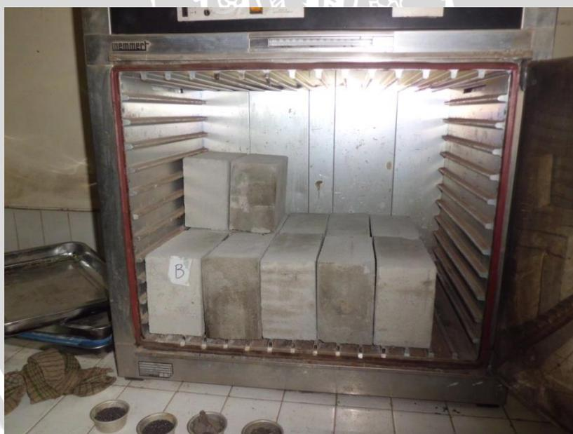
Gambar. Proses Pengeringan Benda Uji dengan Cara di Oven
