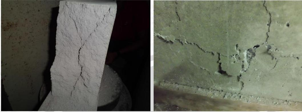
Gambar. Kondisi Benda Uji setelah Proses Pengujian Tekan
