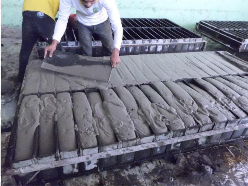
Gambar. Pencetakan Benda Uji
