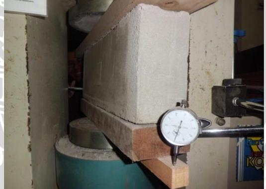
Gambar. Pengujian Kuat Tekan dan Pencatatan Dial
