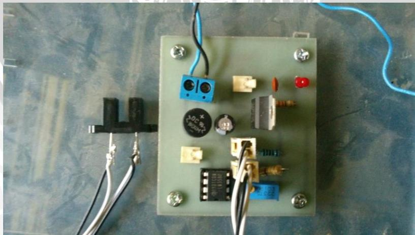
Gambar 1.12 Rangkaian Catu Daya, Sensor, dan OP AMP Komparator
