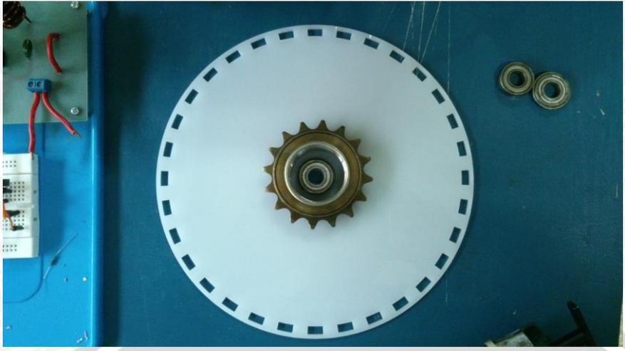
Gambar 1.15 Rangkaian Sensor Rotari
