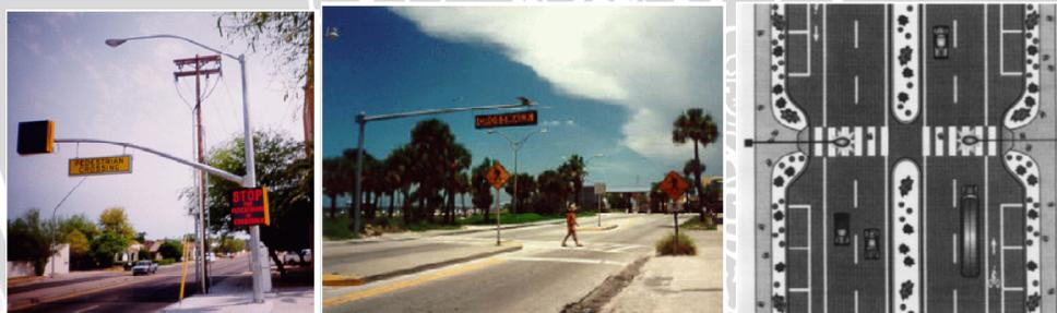
**Gambar 2.20. Bentuk overhead sign (*lighted pedestrian sign*) (kiri) dan bentuk penerangan tambahan di jalur penyeberangan (kanan)**
