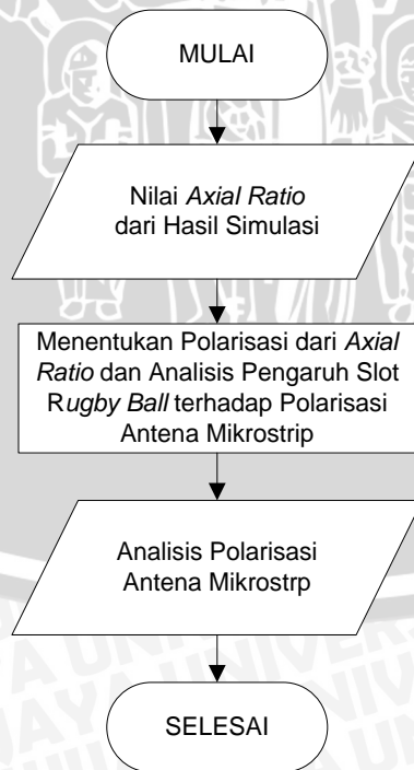
Gambar 3.7 Diagram Alir Analisa Polarisasi Antena Mikrostrip
