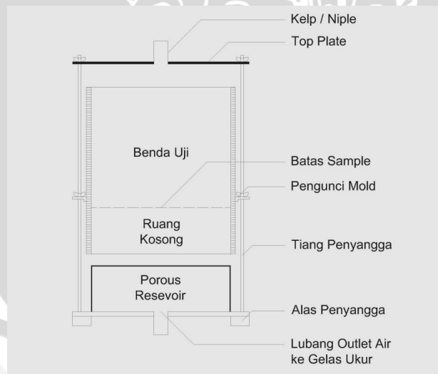
Gambar 3.4 Potongan melintang mold modifikasi constant head sekaligus CBR.
