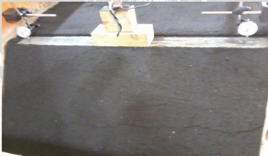
**Gambar 4. 28** Pergeseran lereng akibat tegangan yang ditransfer oleh pondasi
