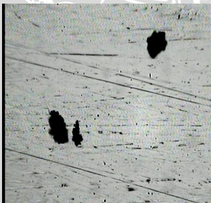
Gambar 4.11 Spesimen pada asam sulfat 95 % dan 240 jam
