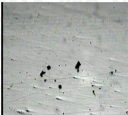
Gambar 4.9 Spesimen pada asam sulfat 90% dan 360 jam
