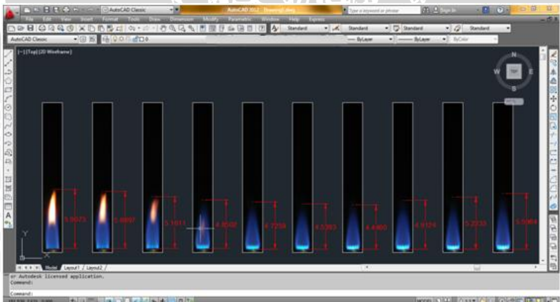
Gambar 4.3 Pengolahan Tinggi Api Pada Software AutoCAD 2012
