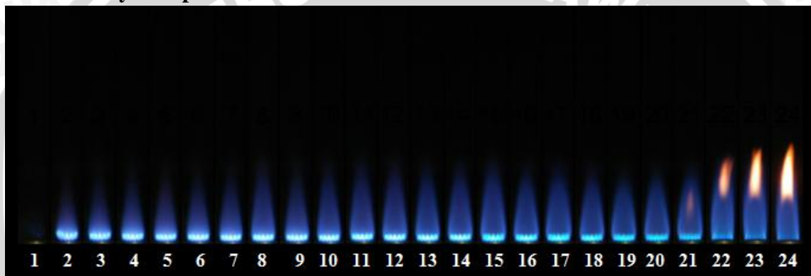
Gambar 4.8 Pola Api Dari Pembakaran Campuran Uap Minyak Jarak Dan Udara
