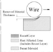
Gambar 1.1 Skema material yang terpengaruh panas
