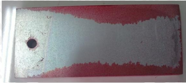
Gambar 4.2 Foto spesimen hasil proses liquid penetrant .
