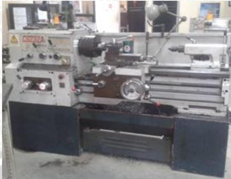
Gambar 3.3 : Mesin bubut Gap - *Bed Lathe* tipe C6232A
