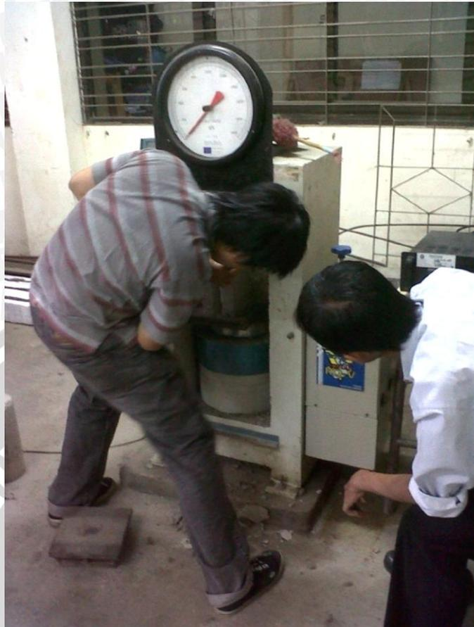
Lampiran 1.11 Pemasangan Batako Pada Alat Uji
