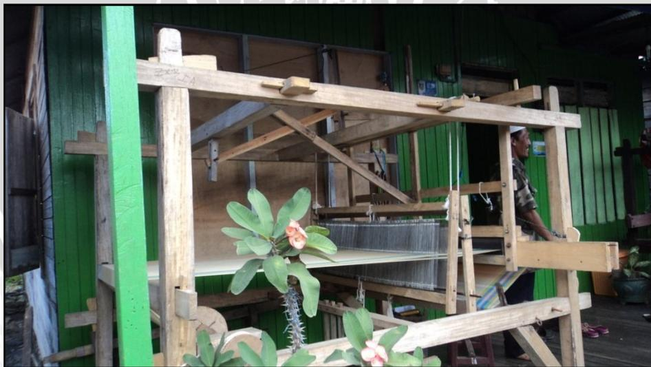
**Gambar 4.11 Alat Tenun Bukan Mesin (ATBM)**
