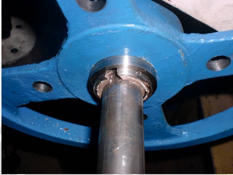
BUSHING TIRUS SEBELUM PENGUJIAN
