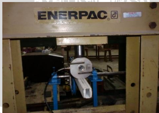
Gambar 3.8 Pemasangan load shell
