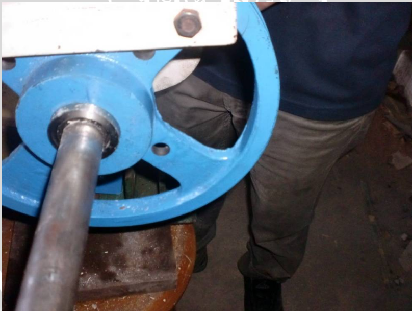
BUSHING TIRUS SETELAH PENGUJIAN
