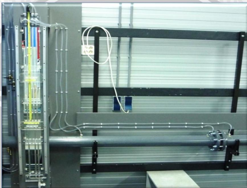
Gambar3.4 : Orifice meter
