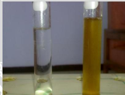
Gambar 2.4 Minyak Transformator
