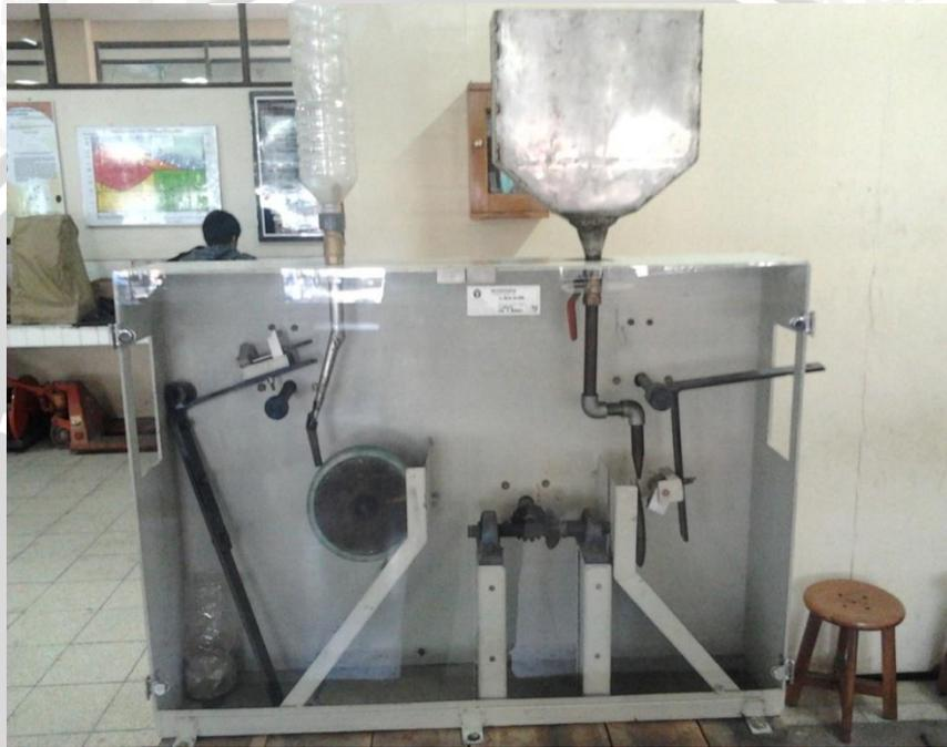
**Gambar 1.1** Alat Uji Keausan
