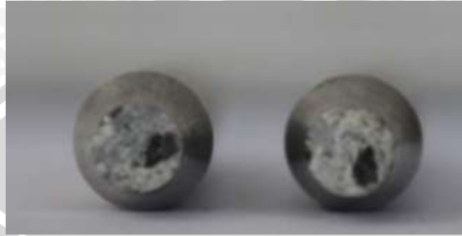
Gambar 4.5 Terak Pada Patahan Spesimen
