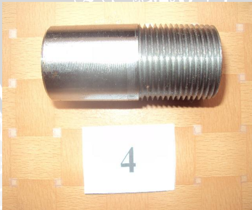
Spesimen dengan variasi putaran spindle 500 rpm dan depth of cut 0,0203 mm
