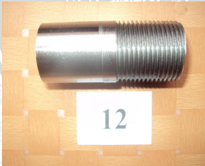
Spesimen dengan variasi putaran spindle 600 rpm dan depth of cut 0,0407 mm
