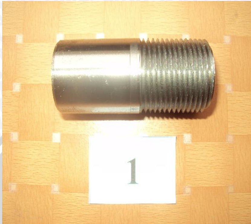
Spesimen dengan variasi putaran spindle 200 rpm dan depth of cut 0,0203 mm
