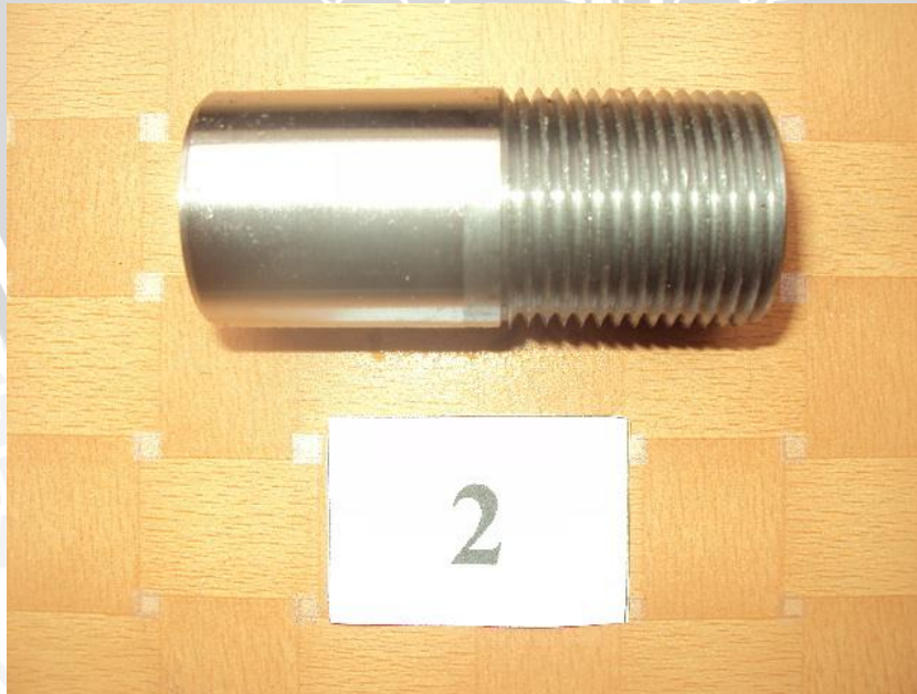
Spesimen dengan variasi putaran spindle 300 rpm dan depth of cut 0,0203 mm
