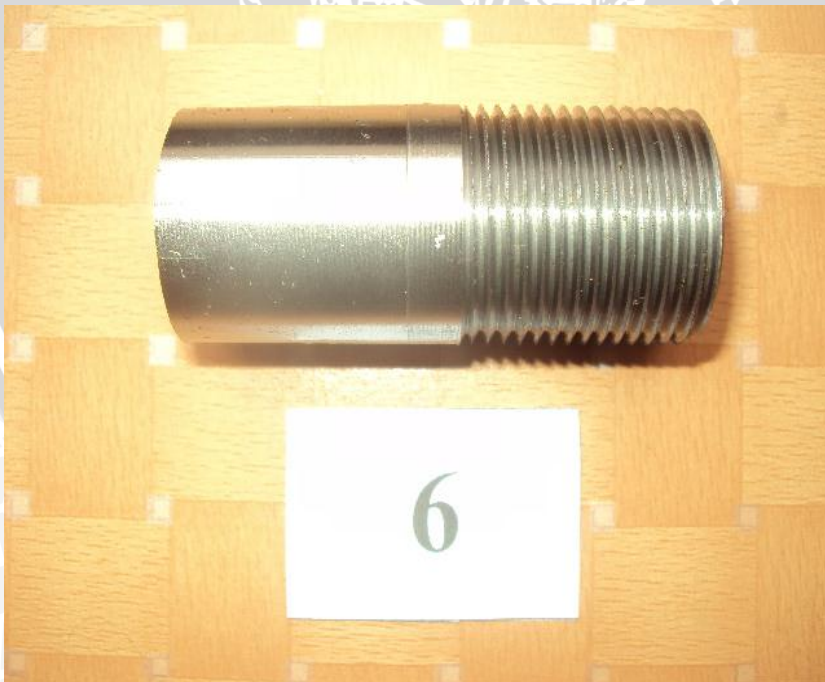
Spesimen dengan variasi putaran spindle 700 rpm dan depth of cut 0,0203 mm
