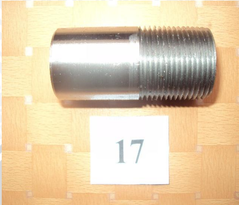
Spesimen dengan variasi putaran spindle 400 rpm dan depth of cut 0,0610 mm
