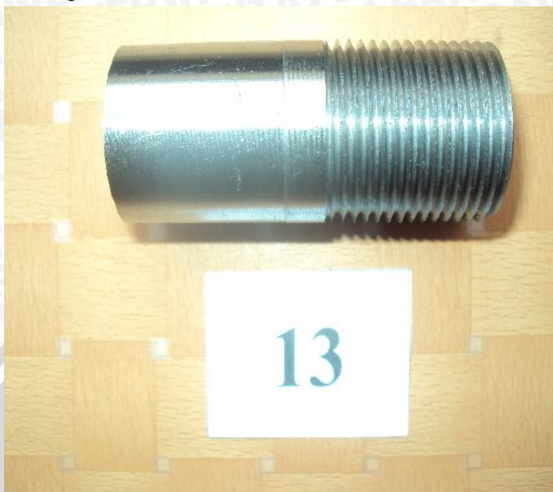
Spesimen dengan variasi putaran spindle 700 rpm dan depth of cut 0,0407 mm
