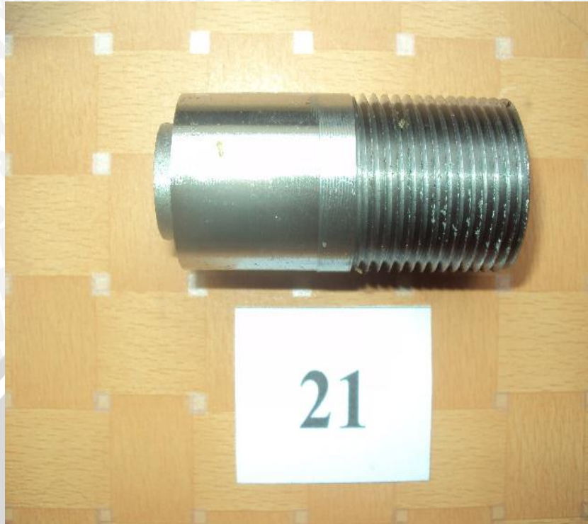
Spesimen dengan variasi putaran spindle 800 rpm dan depth of cut 0,0610 mm
