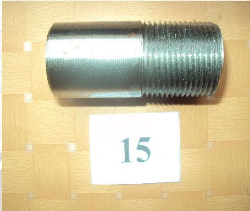
Spesimen dengan variasi putaran spindle 200 rpm dan depth of cut 0,0610 mm
