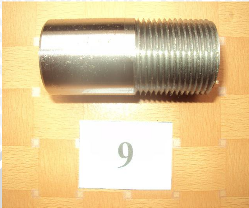
Spesimen dengan variasi putaran spindle 300 rpm dan depth of cut 0,0407 mm
