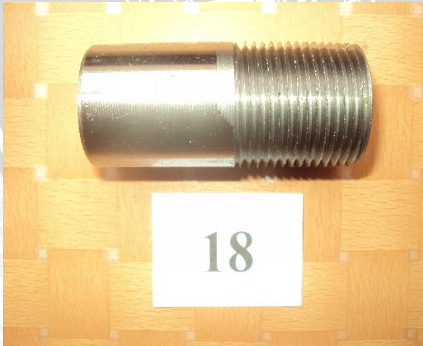
Spesimen dengan variasi putaran spindle 500 rpm dan depth of cut 0,0610 mm
