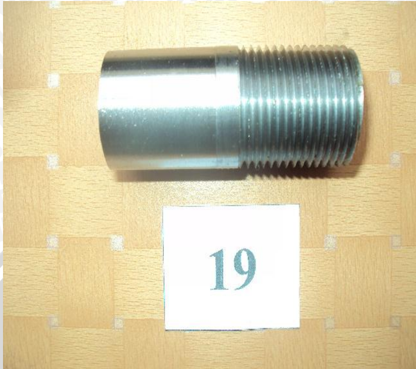
Spesimen dengan variasi putaran spindle 600 rpm dan depth of cut 0,0610 mm
