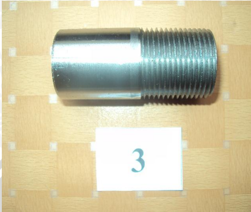
Spesimen dengan variasi putaran spindle 400 rpm dan depth of cut 0,0203 mm
