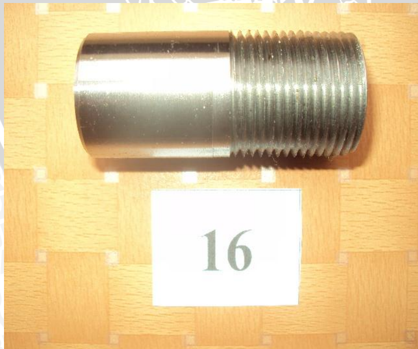
Spesimen dengan variasi putaran spindle 300 rpm dan depth of cut 0,0610 mm
