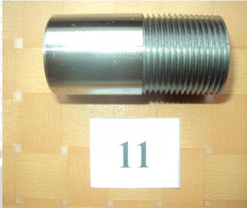
Spesimen dengan variasi putaran spindle 500 rpm dan depth of cut 0,0407 mm
