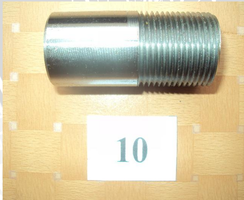
Spesimen dengan variasi putaran spindle 400 rpm dan depth of cut 0,0407 mm
