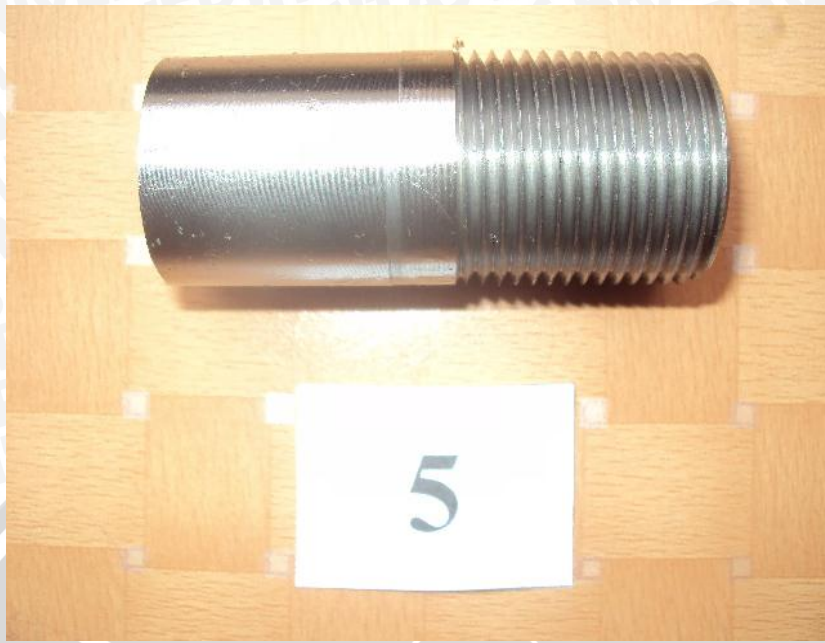
Spesimen dengan variasi putaran spindle 600 rpm dan depth of cut 0,0203 mm
