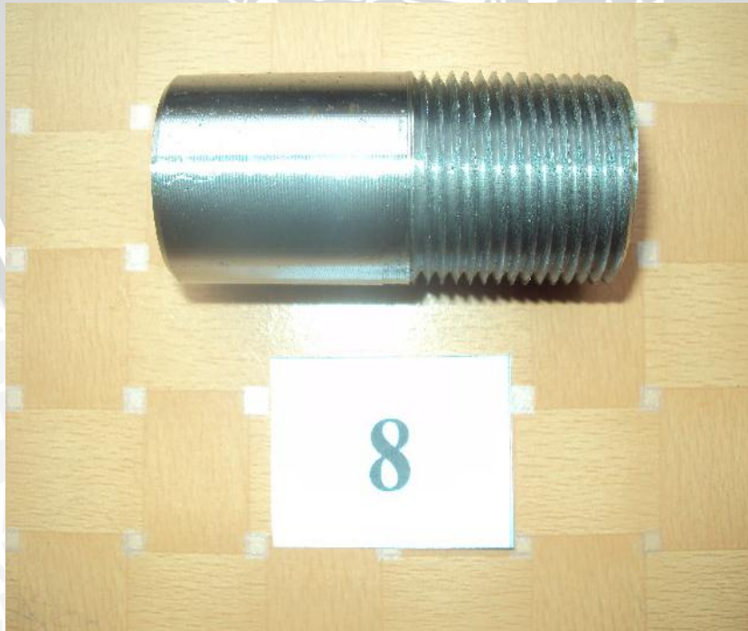
Spesimen dengan variasi putaran spindle 200 rpm dan depth of cut 0,0407 mm
