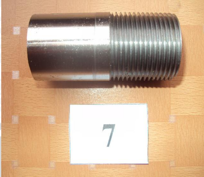
Spesimen dengan variasi putaran spindle 800 rpm dan depth of cut 0,0203 mm
