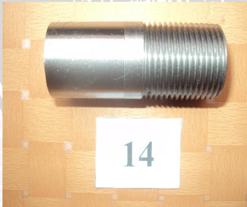
Spesimen dengan variasi putaran spindle 800 rpm dan depth of cut 0,0407 mm
