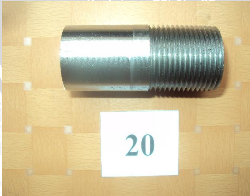
Spesimen dengan variasi putaran spindle 700 rpm dan depth of cut 0,0610 mm
