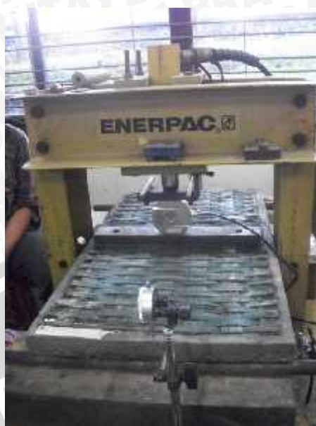
Gambar 3. Pengujian lentur panel lapis gedek
