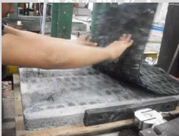
Gambar 4. Peninjauan retakan panel lapis gedek
