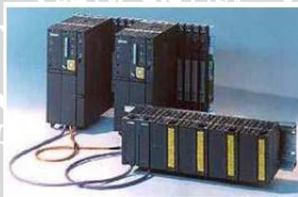
**Gambar 2.11** Dua Siemens SIMATIC S7 PLC *Boxes* terkoneksi ke *DP-slaves*
