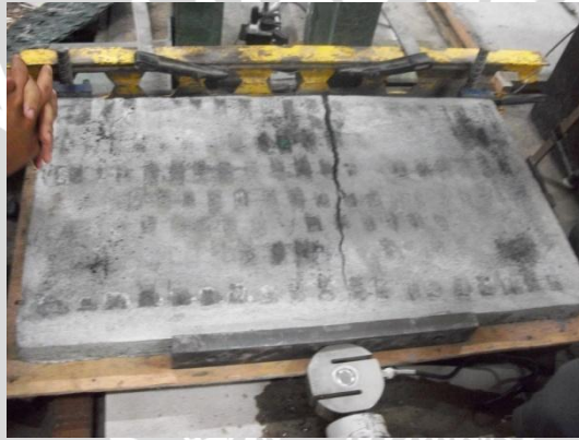
Gambar L.8 Pola Retak akibat Pengujian Geser
