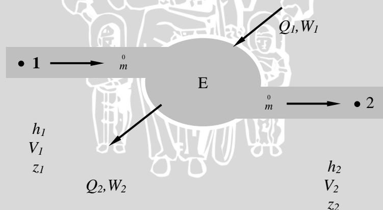
Gambar 2.2. Keseimbangan energi pada sebuah volume atur yang sedang mengalami laju aliran mantap
