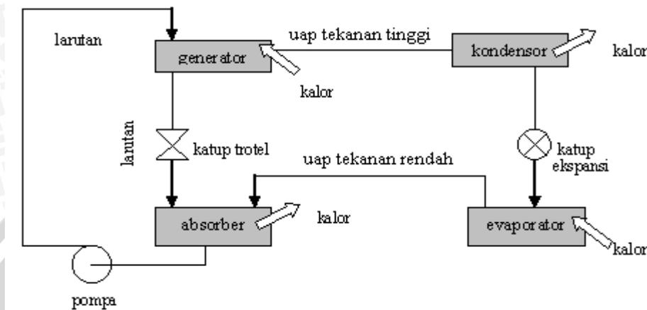
Gambar 2.8. Diagram skematik komponen mesin pendingin siklus absorpsi
