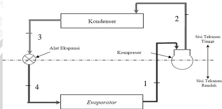
Gambar 2.3. Diagram skematik komponen mesin pendingin siklus kompresi uap
