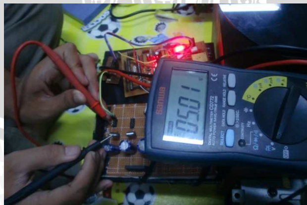
Gambar 5.3 Hasil Pengujian Catu Daya Menggunakan Multimeter untuk rangkaian mikrokontroler
