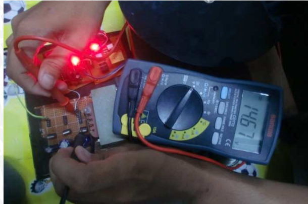
Gambar 5.1. Hasil Pengujian Catu Daya Menggunakan Multimeter untuk driver motor
