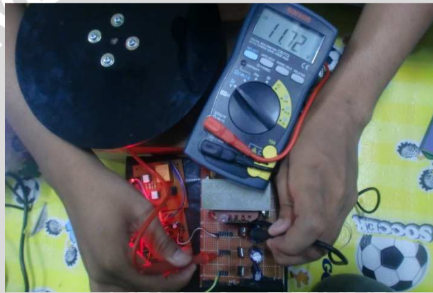
Gambar 5.2 Hasil Pengujian Catu Daya Menggunakan Multimeter untuk mengaktifkan coil relay
