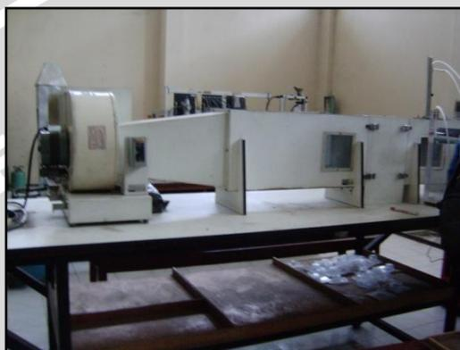
Gambar 3.1 : *Wind Tunnel*
