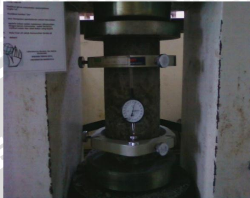
Gambar 4.5 Skema pengujian kuat tekan beton
