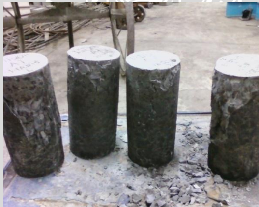
Gambar 4.6 Beton setelah diuji kuat tekan
