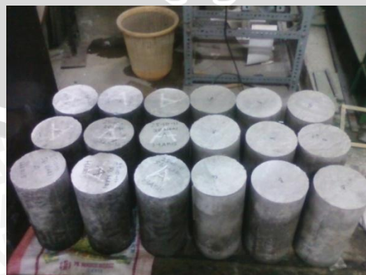
Gambar 4.4 Kumpulan beton yang telah siap diuji
