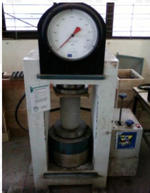
Gambar 2.3 Uji Kuat Tekan
