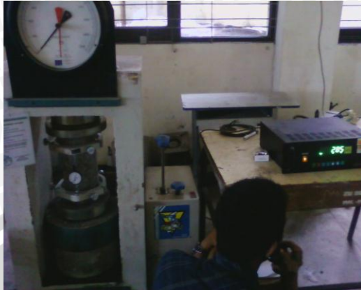
Gambar Proses pengujian beton
