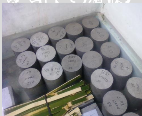
Gambar saat pengkuringan beton
