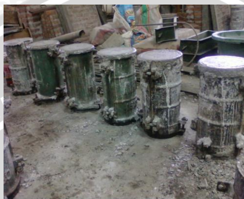
Gambar saat pencetakan beton silinder
