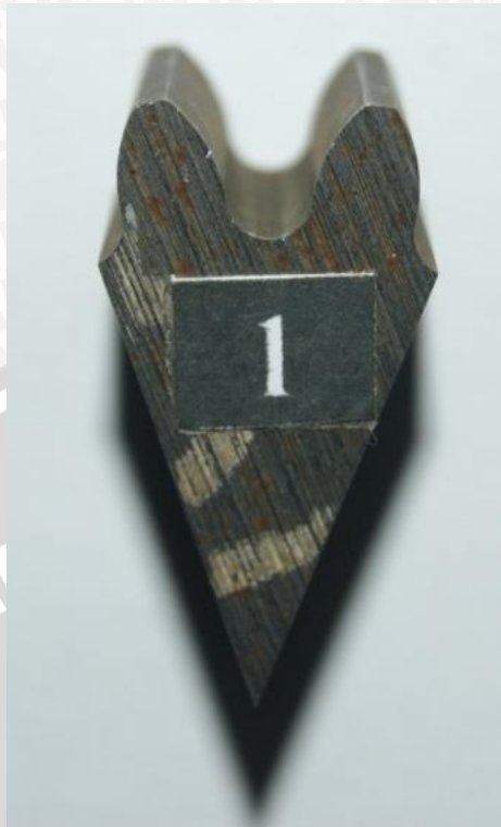
Spesimen dengan variasi arus listrik 2 ampere dan wire feed rate 3 mm/s
