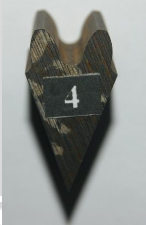
Spesimen dengan variasi arus listrik 8 ampere dan wire feed rate 3 mm/s
