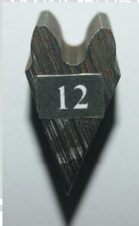
Spesimen dengan variasi arus listrik 8 ampere dan wire feed rate 5 mm/s
