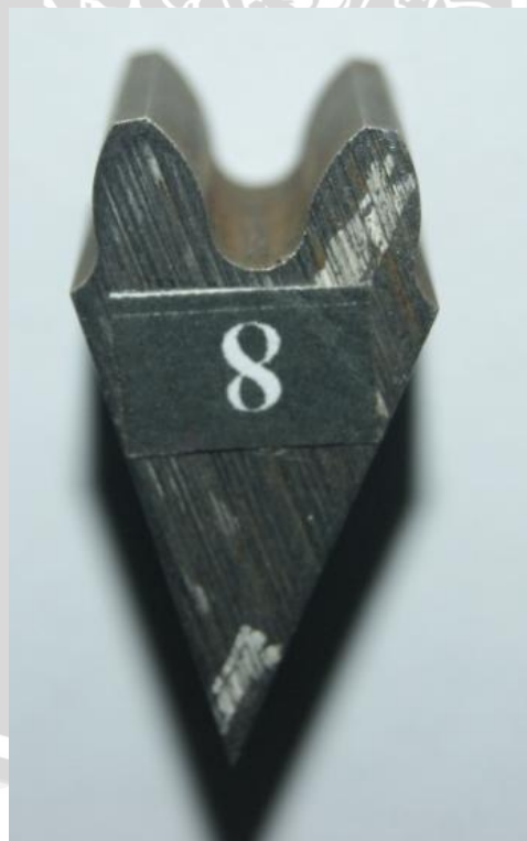
Spesimen dengan variasi arus listrik 8 ampere dan wire feed rate 4 mm/s
