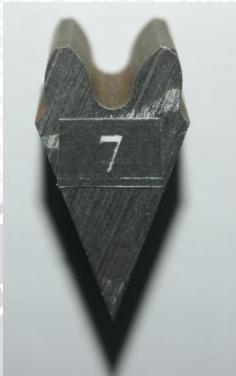
Spesimen dengan variasi arus listrik 6 ampere dan wire feed rate 4 mm/s
