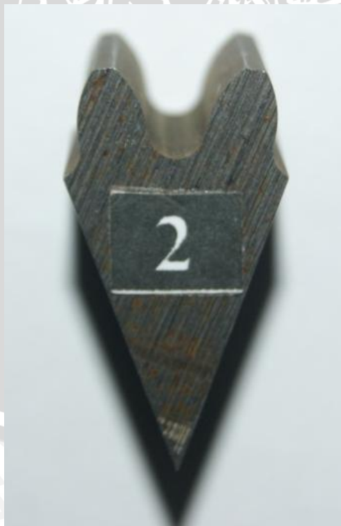
Spesimen dengan variasi arus listrik 4 ampere dan wire feed rate 3 mm/s
