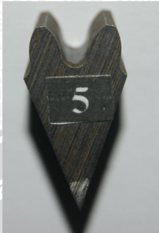
Spesimen dengan variasi arus listrik 2 ampere dan wire feed rate 4 mm/s
