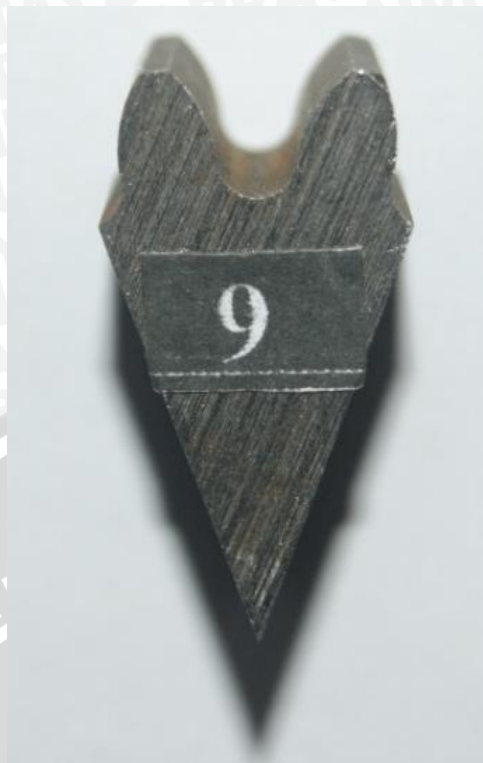
Spesimen dengan variasi arus listrik 2 ampere dan wire feed rate 5 mm/s
