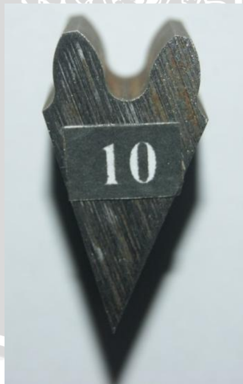
Spesimen dengan variasi arus listrik 4 ampere dan wire feed rate 5 mm/s
