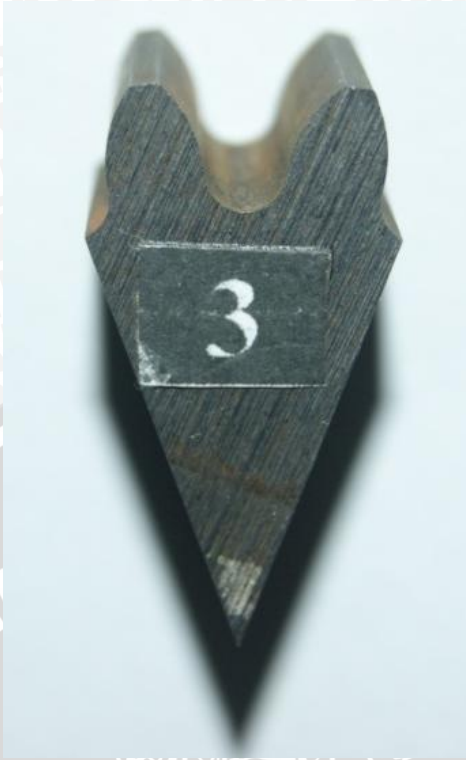
Spesimen dengan variasi arus listrik 6 ampere dan wire feed rate 3 mm/s
