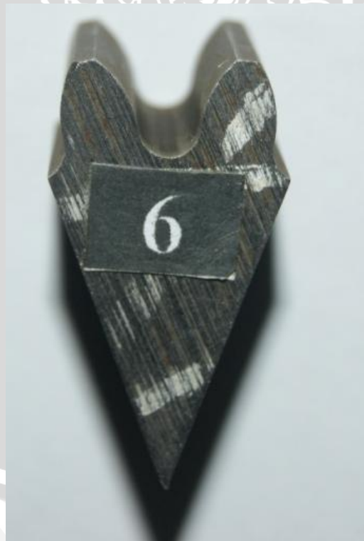
Spesimen dengan variasi arus listrik 4 ampere dan wire feed rate 4 mm/s
