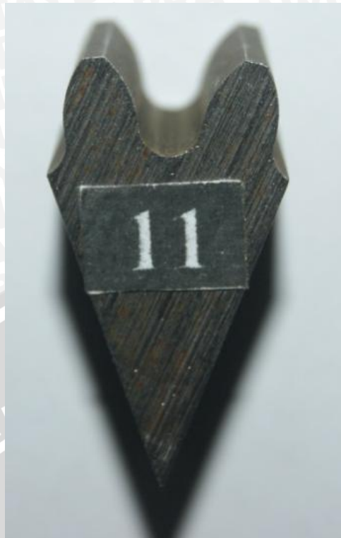
Spesimen dengan variasi arus listrik 6 ampere dan wire feed rate 5 mm/s
