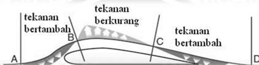
Gambar 2.13 Momentum Mempengaruhi Aliran Udara Pada *Airfoil*
