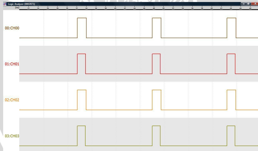
Gambar 5.6 Sinyal PWM Waktu Kondisi Berputar
