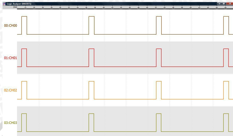
Gambar 5.5 Sinyal PWM Waktu Kondisi Diam
