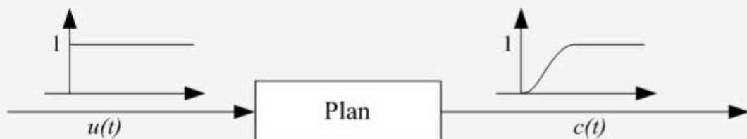
Gambar 2.9 Respon Plant Terhadap Masukan Berupa Unit Step
