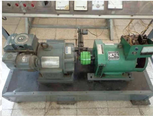
Motor penggerak dan generator sinkron
