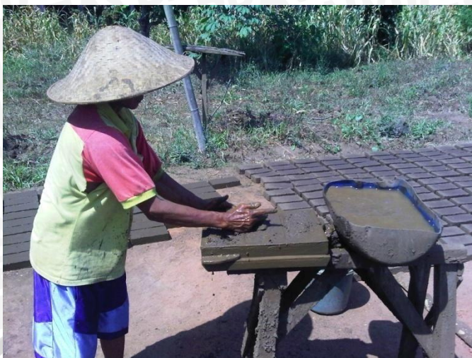
Gambar 4.3 Proses Pencetakan Batu Bata
