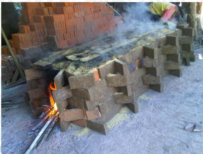
Gambar 4.6 Proses Pembakaran Batu Bata
