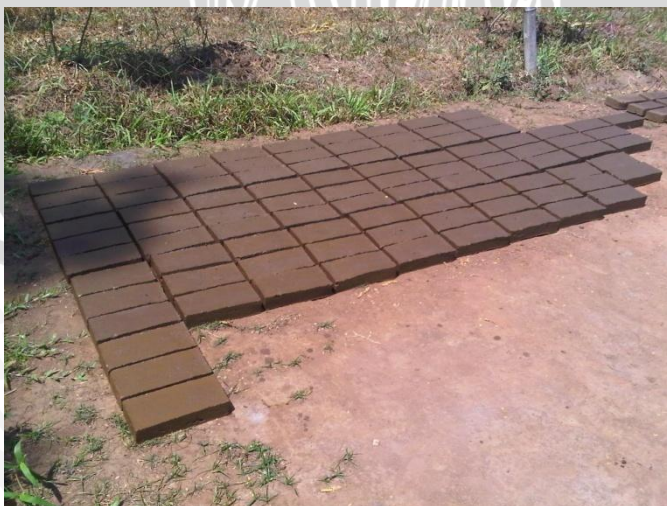
Gambar 4.5 Proses Penjemuran Batu Bata
