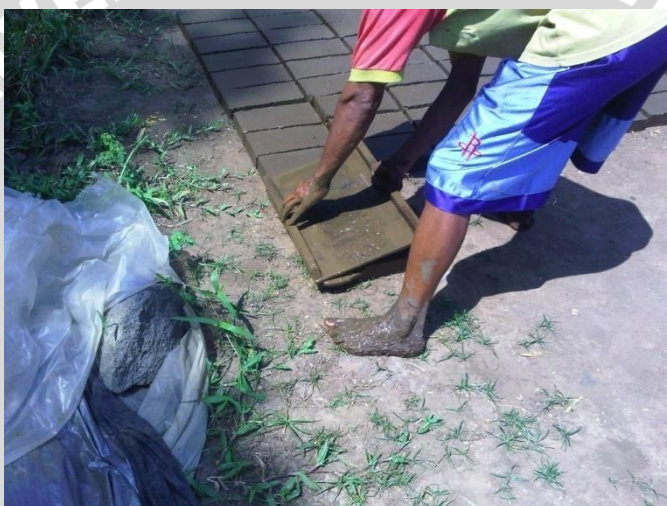
Gambar 4.4 Proses Pelepasan Batu Bata Dari Cetakan
