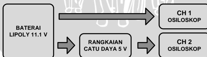
Gambar 5.1 Blok Diagram Pengujian Rangkaian Catu Daya 5 V
