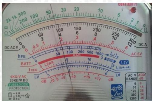
$I_B = 0,9 \text{ mA}$ . Skala 3 mA
