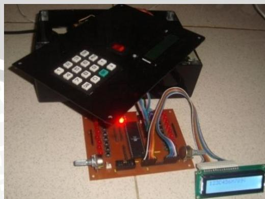
Gambar 5.22 Pengujian Rangkaian Modul Keypad
