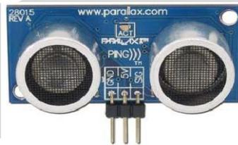
Gambar 2.5 Sensor Ultrasonik PING)))
