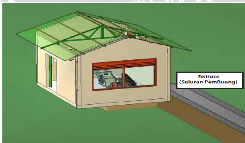
Gambar 2.28 Saluran Bawah ( Tailrace )
