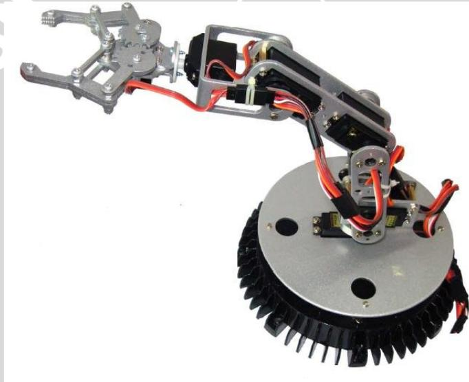
**Gambar 4.2** Robot Lengan Daggu Hi-tech dan Servomotor
