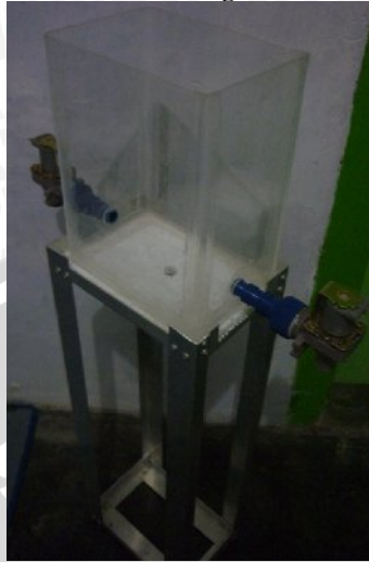
Gambar 5 Model Miniatur Plant Tangki Air Ukuran 15x10x20 (cm 3 )
