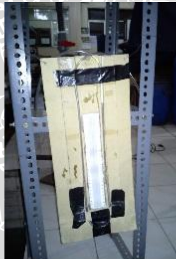
Gambar 3.7 : Manometer Pipa-U Fluida Raksa
