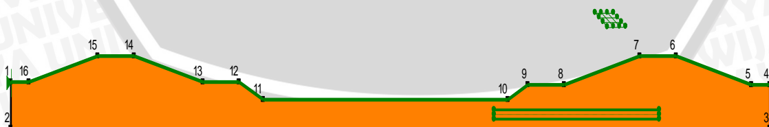
Gambar 4.30. Stabilitas Tanggul Kanan Patok 15 Sungai Pikatan
