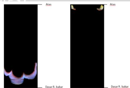
Gambar 6 Batas rambatan api pada ruang bakar.
