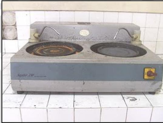
Gambar 3.2 *Centrifugal Sand Paper Machine*
