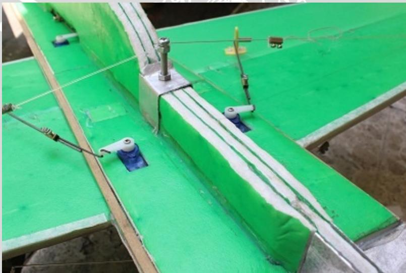
Foto Penempatan Motor Servo Sebagai Penggerak *Aileron*
