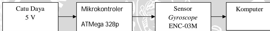
Gambar 5.2 Diagram Blok Pengujian Sensor Gyroscope
