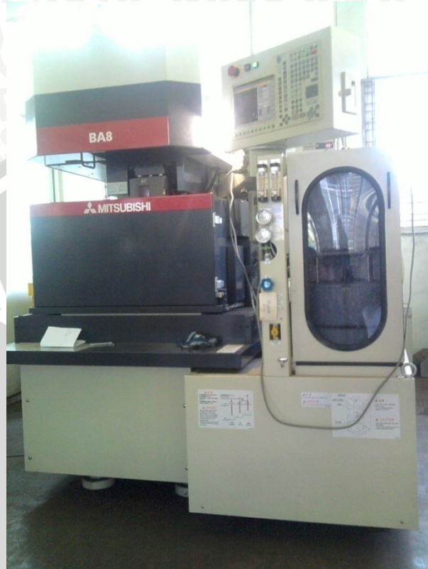
Gambar 3.1 Mesin Wire EDM Mitsubishi BA-8 Sumber: Dokumentasi Pribadi
