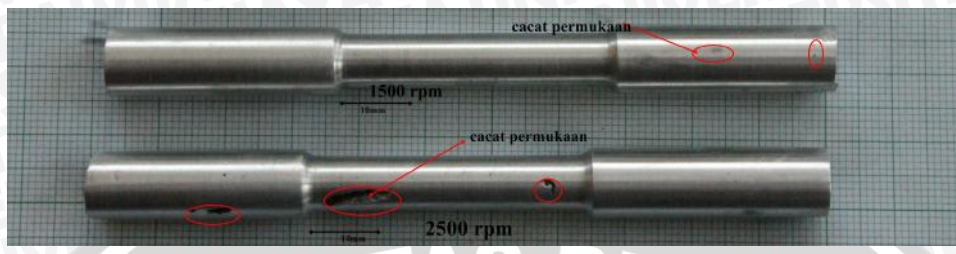
Gambar 4.5 Cacat permukaan pada spesimen uji puntir
