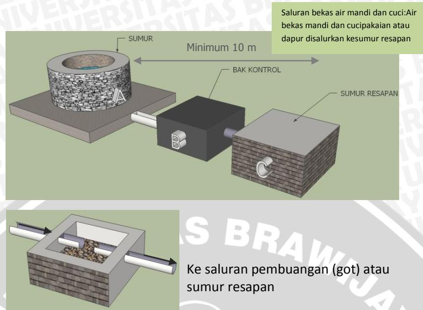
**Gambar 4. 40 Bak saluran limbah cair rumah tangga (tanpa tinja) di Darat**
