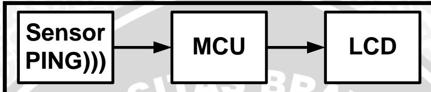
Gambar 5.3 Diagram Blok Pengujian Sensor Ultrasonik
