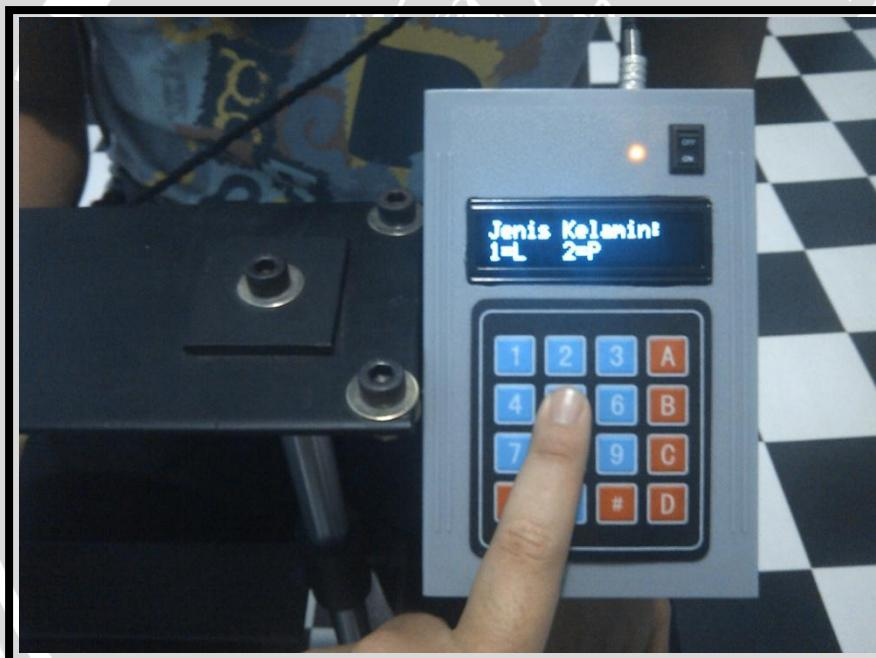
Gambar 5.14 (b) Tampilan LCD untuk pemasukkan jenis kelamin yang salah
