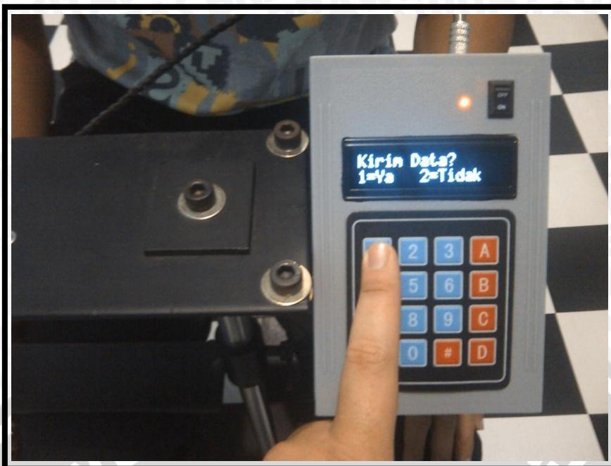
Gambar 5.19 Tampilan LCD untuk memilih proses mengirim data
