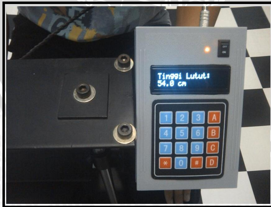
Gambar 5.18 Tampilan LCD mengukur tinggi lutut
