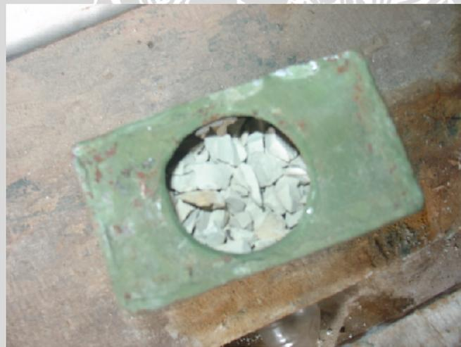
peletakan zeolit di dalam purifier
