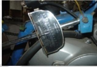
Gambar 3.3 *Dynamometer Prony Brake*.
