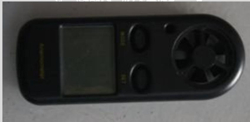
Gambar 3.10 *Anemometer*
